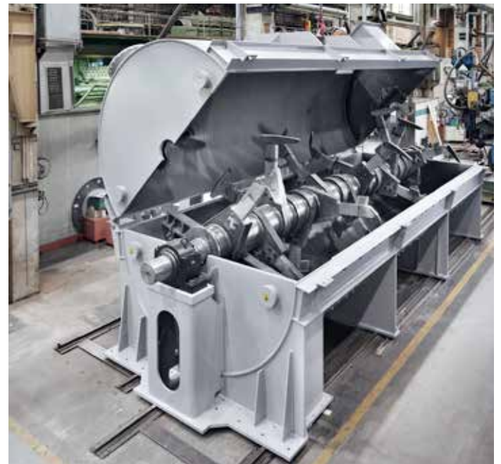
Lödige Pflugschar®-Mischer für kontinuierlichen Betrieb Typ KM 57000 SIN mit geteilter Mischtrommel
