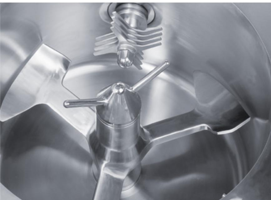
Mischwerkzeug mit Werkzeugehebevorrichtung
