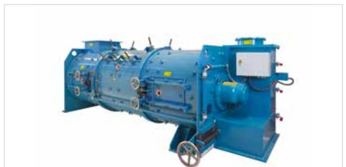
Lödige Pflugschar®-Mischer für kontinuierlichen Betrieb Typ KM-D, Sonderausführung mit austauschbarer Verschleißauskleidung
