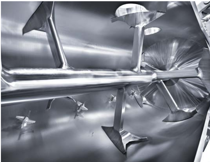
Verschweißtes Mischwerk im hygienischen Design
