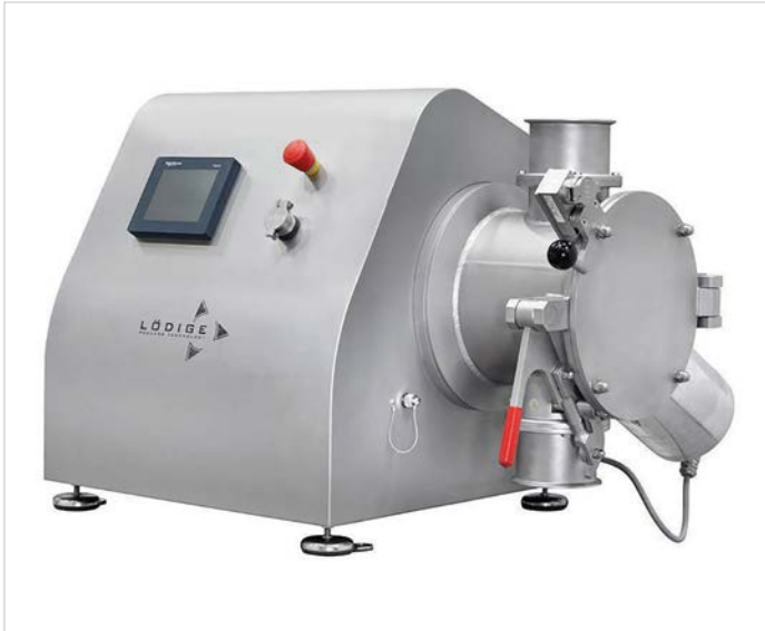
Labor-Pflugschar®-Mischer mit Wechseltrommeln
