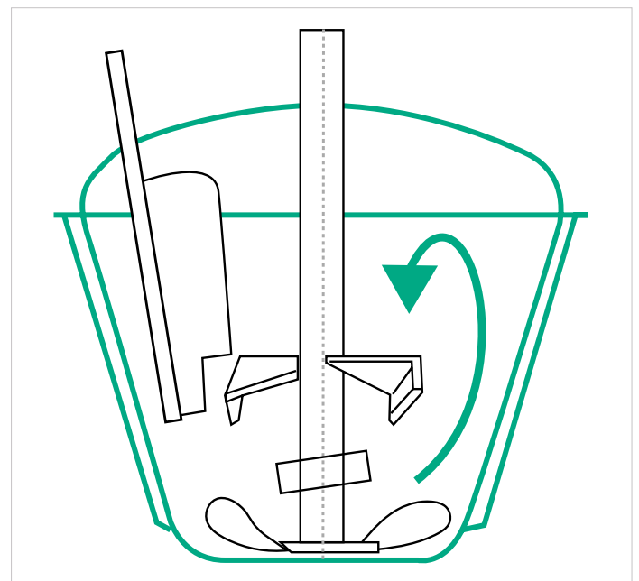
Mischprinzip des Nassmischers NOHK
