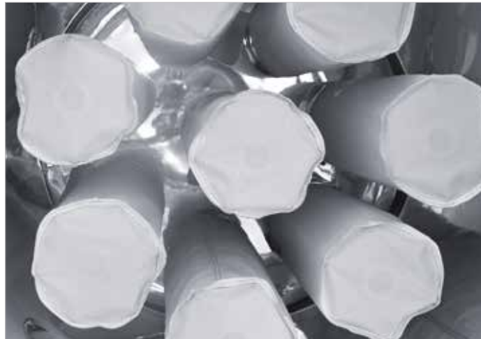
Filterelemente des LFP
