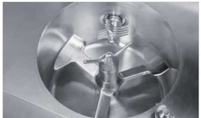
3-flügeliges Mischwerkzeug und Messerkopf
